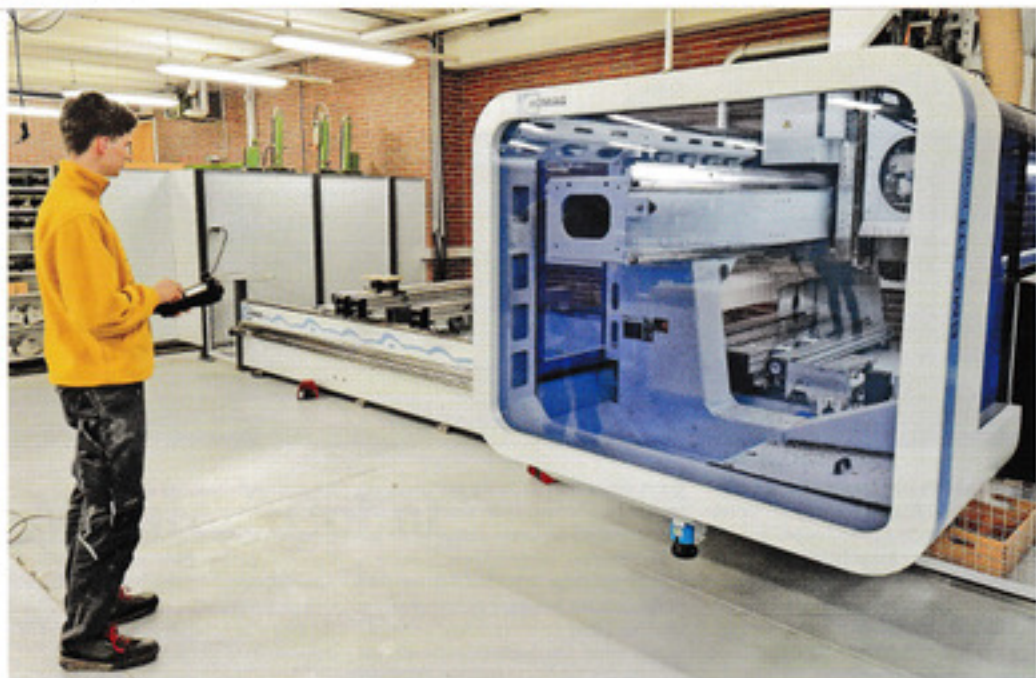
Herzstück der Ausbildung ist der Maschinenraum mit CNC-Bearbeitungszentrum und Plättensäge von Homag.
